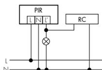
Per la commutazione con lampade fluorescenti, ecc. è eventualmente necessario l'uso di un circuito RC.
