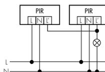
Non è consigliato collegare più di 5 rilevatori di movimento in parallelo. Collegando un più elevato numero di rilevatori, si possono verificare attivazioni indesiderate a causa dell'ampliamento rispettivamente della mancanza di chiarezza della zona di rilevamento.
